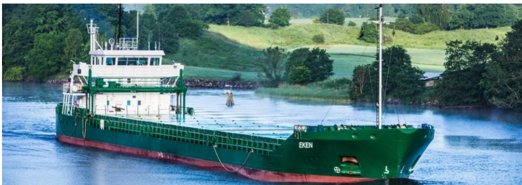
MS Eken, en av Thunbolagens torrlastare i Vänermax-storlek (max 89 m långa och 13,4 m breda), är ett exempel på den småskaliga IMO-sjöfarten. Fartyget med 4 800 dwt är anpassat för slussarna i Trollhättan. Foto: Erik Thun AB
