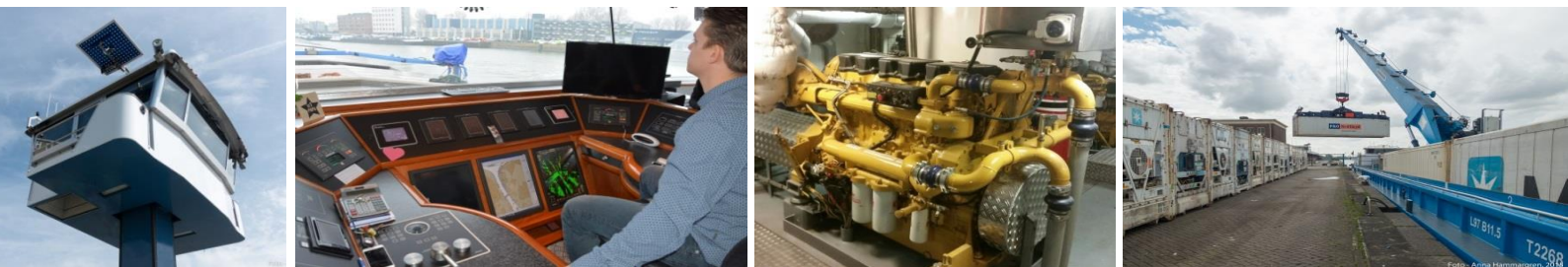
Från vänster; pråmfartygens höj- och sänkbara styrhytt (som klarar lägre brohöjder), den avancerade bryggutrustningen, pråmfartygets lastbilsmotor och containerpråmen som med den egna kranen själv lastar containrar uppställda vid ett enkelt kajutrymme. Pråmfartygen samspelar med samhället på samma sätt som lastbilen och utgör en länk mellan trafikslagen. Foto: Johan Lantz och Anna Hammargren
